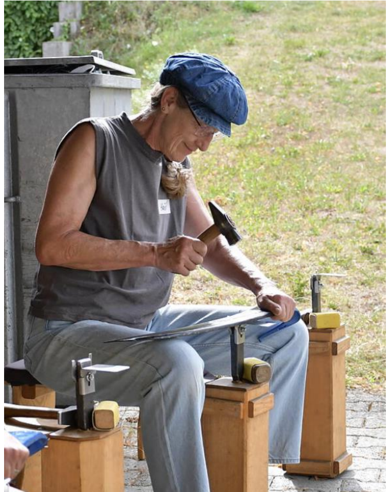
Heidi Gfeller bearbeitet mit dem Hammer auf dem Dengelamboss ein Sensenblatt. Foto: dvd
